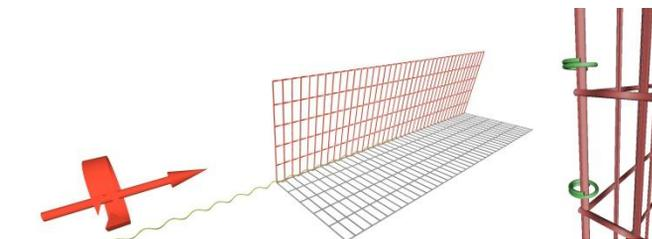
Pour un montage avec agrafes, les hélices sont remplacées par 1 agrafe tous les 10 cm
